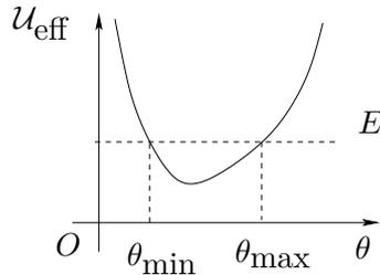
Quando  $U'_{\text{eff}} = 0$ , ovvero al minimo valore possibile per  $E$ , il pendolo si muove di moto circolare; per valori maggiori di  $E$  il pendolo si muove tra un  $\theta_{\text{min}}$  e un  $\theta_{\text{max}}$ .
