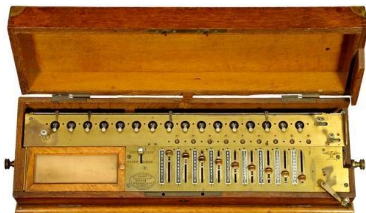
Figure 8 - L'arithmomètre : Charles-Xavier Thomas de Colmar.
